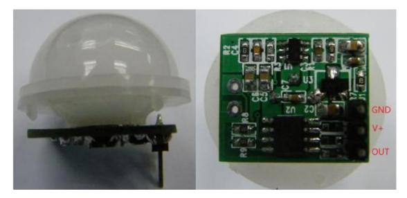
Module input voltage : 3.3~7V
