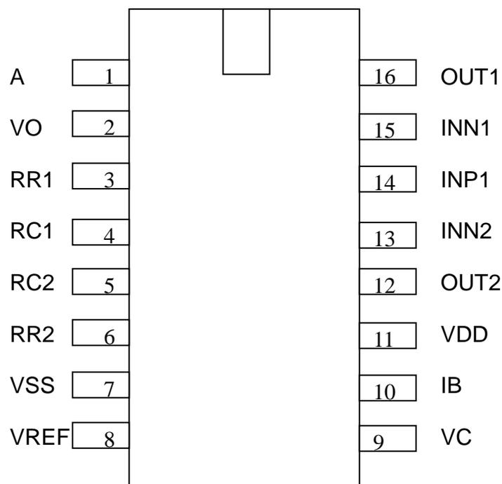
图1 TT0001(相容 BISS0001)外引线连接图
